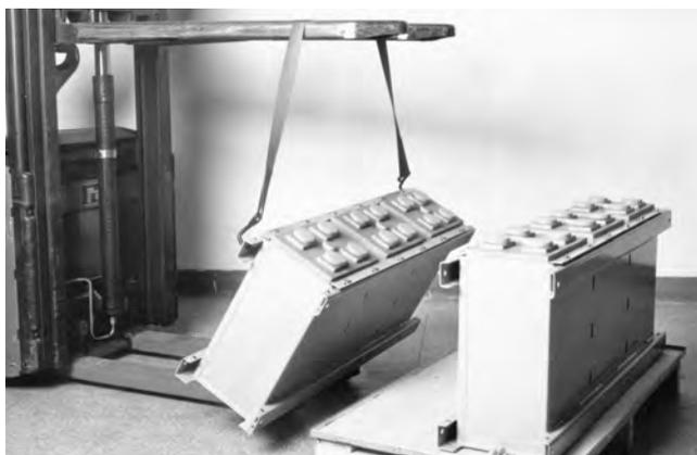
Рис. 4: Подъем ящика с модулями с поддона
